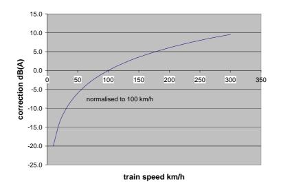
Figure 6 : Rolling Noise Speed Correction
